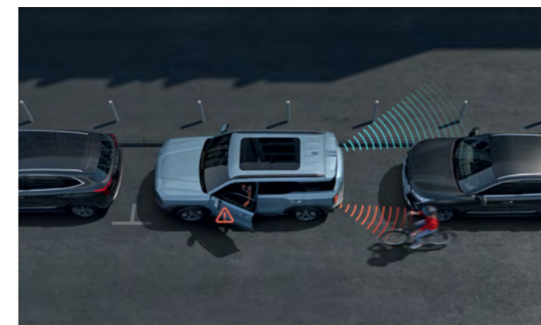
Предупреждение об открытой двери
