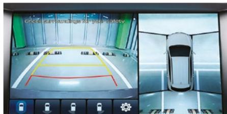
**Система кругового обзора (AVM).** Благодаря установленным на автомобиль передней, задней и боковым камерам, система AVM обеспечивает обзор 360°, позволяя водителю полностью контролировать пространство вокруг автомобиля (включая слепые зоны) в различных условиях движения.
