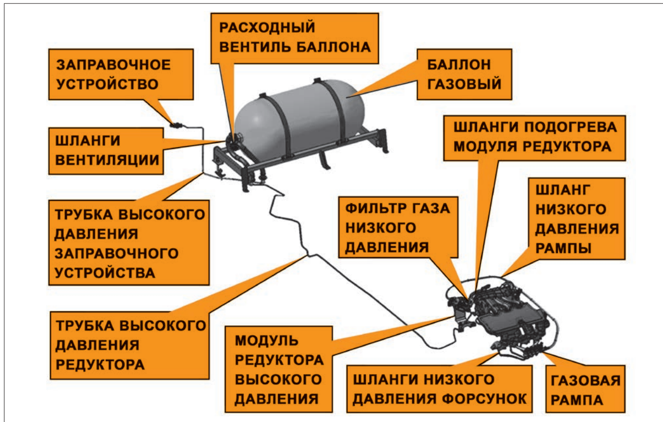
Схема соединений элементов газобаллонного оборудования в автомобиле LADA Largus CNG
