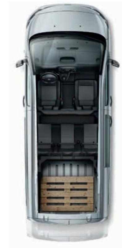
**Грузовое пространство:** впечатляющая длина грузового отделения (по полу) до 2.36 м и максимальная высота грузового отделения 1.39 м.
