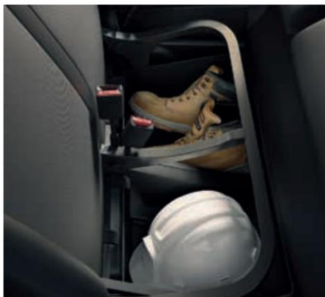
**Пассажирский диван со встроенным отсеком для хранения<sup>1</sup>:** под подушками пассажирского дивана<sup>1</sup> предусмотрен дополнительный отсек объемом до 60 л для хранения рабочего оборудования и других важных вещей.
