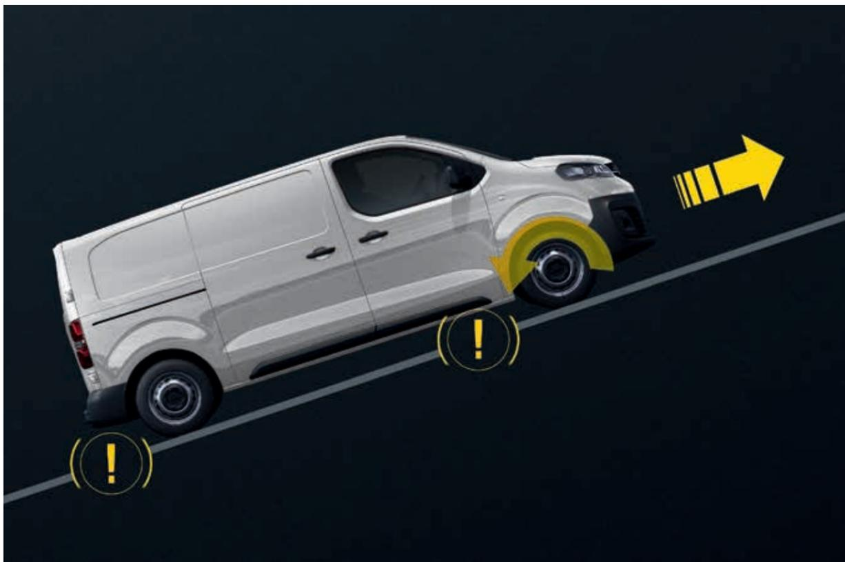
**Система помощи при подъеме** сдерживает скатывание автомобиля назад при остановке на уклоне и удерживает тормоз, пока вы переключаетесь с педали тормоза на педаль газа. Как только вы нажимаете на педаль акселератора, система отпускает тормоз.
