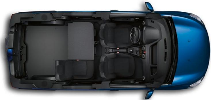
— Заднее сиденье со спинкой, складываемой в соотношении 1/3–2/3, позволяет увеличить длину погрузки до 1 570 мм при посадке водителя и двух пассажиров.
