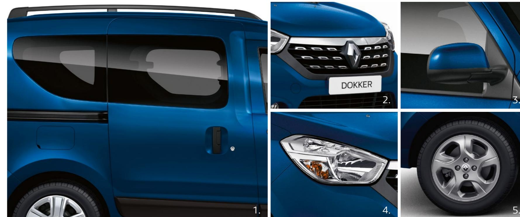
**1. Широкий проем сдвижных дверей (703 мм)** дает максимальный доступ к заднему ряду сидений. **2. Стильный передний бампер с хромированными элементами и противотуманные фары\***, обеспечивающие лучшую видимость в условиях дождя и тумана. **3. Зеркала заднего вида с электроприводом и подогревом\***, окрашенные в цвет кузова. **4. Двойная оптика фар с дневными ходовыми огнями** обеспечивает хорошую видимость. **5. Стильные 15" легкосплавные\*** диски колес.
