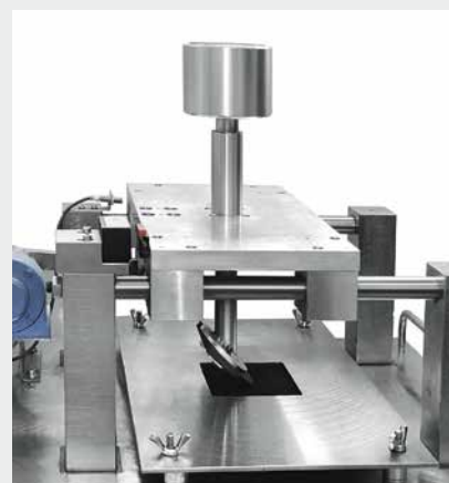
Устройство для проведения «испытания каблуком»
