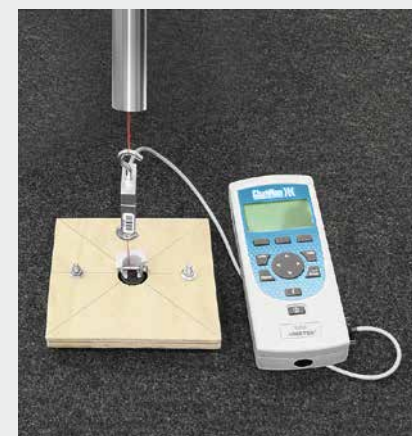
Тестирование прочности фиксаторов для ковриков
