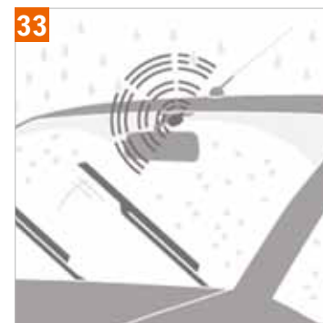
33 | Датчик дождя. Автоматически включает дворники лобового стекла, подбирает оптимальный режим и интервал их работы.
