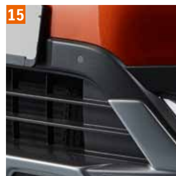
15| Датчики парковки, передние. Со звуковой индикацией. Сенсоры могут быть окрашены в цвет кузова. Комплект из 4 шт. 990E0-61M56-010
