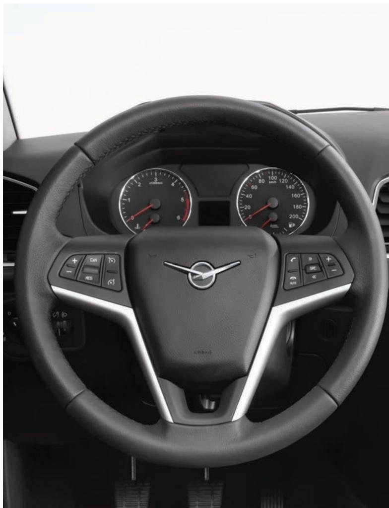
Мультифункциональный руль в новом дизайне с управлением круиз-контролем и ограничителем скорости, мультимедийной системой и системой громкой связи
