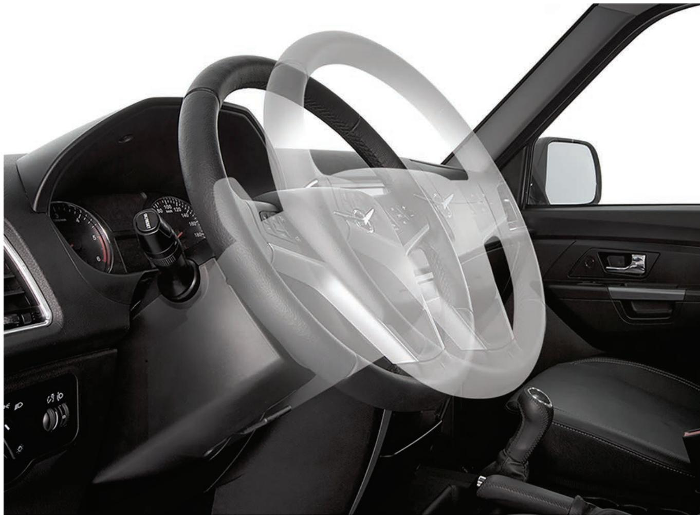
В обновленном УАЗ Патриот регулировка рулевого колеса осуществляется как по углу наклона, так и по вылету
