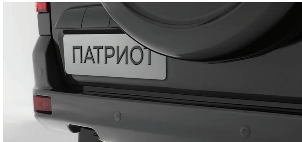
Задние датчики парковки на бампере и камера заднего вида в ручке задней двери
