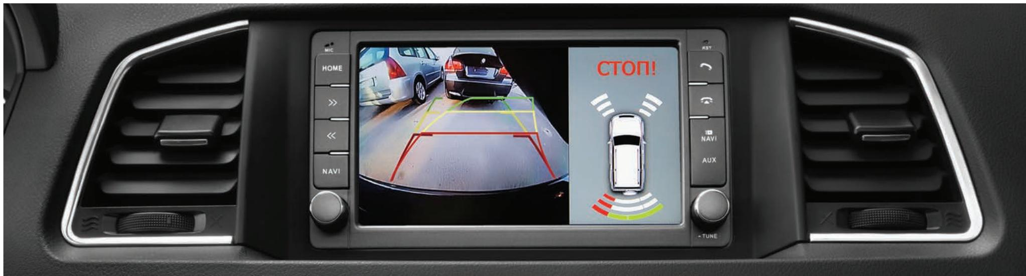
При движении задним ходом на цветной экран выводится изображение с камеры заднего вида с динамическими линиями и работа задних и передних датчиков парковки
