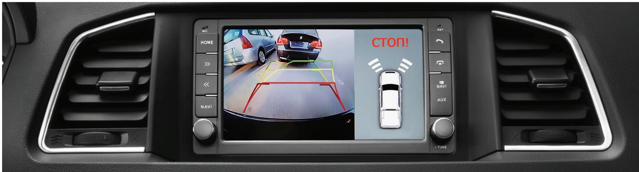
При движении задним ходом на цветной экран выводится изображение с камеры заднего вида с динамическими линиями и работа передних датчиков парковки
