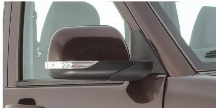
Зеркала заднего вида в цвет кузова со встроенными повторителями поворотов
