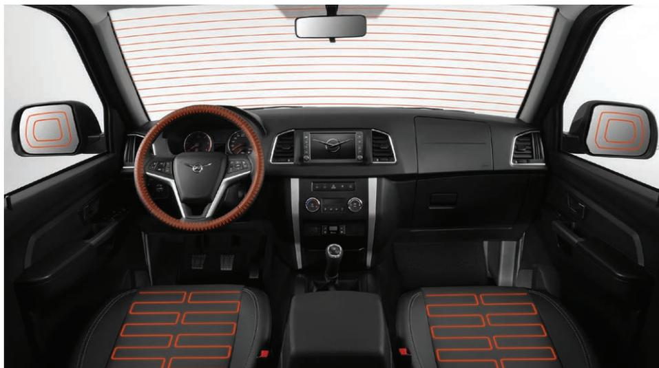
Обогрев рулевого колеса, передних сидений, лобового стекла, боковых зеркал и заднего стекла
