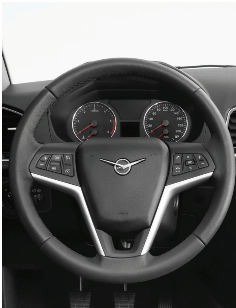
Мультифункциональный руль нового дизайна с управлением круиз-контролем и ограничителем скорости, мультимедийной системой и системой громкой связи
