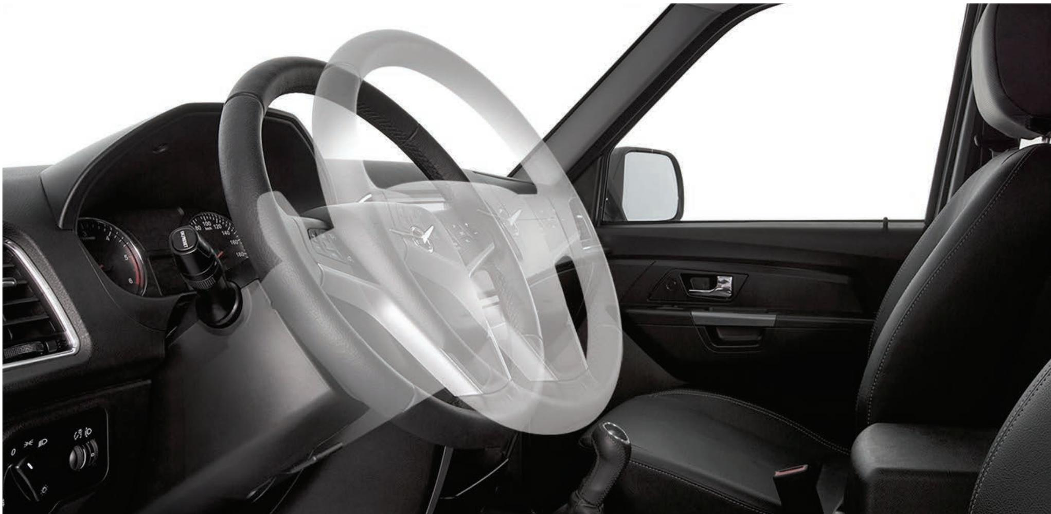
В обновленном УАЗ Пикап регулировка рулевого колеса осуществляется как по углу наклона, так и по вылету
