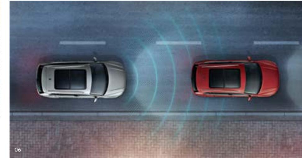
06 Адаптивный круиз-контроль автоматически регулирует скорость автомобиля в диапазоне от 0 до 160 км/ч в зависимости от скорости движущегося впереди транспорта и поддерживает заданную дистанцию до него, облегчая управление на дороге с плотным движением и даже в пробке.
