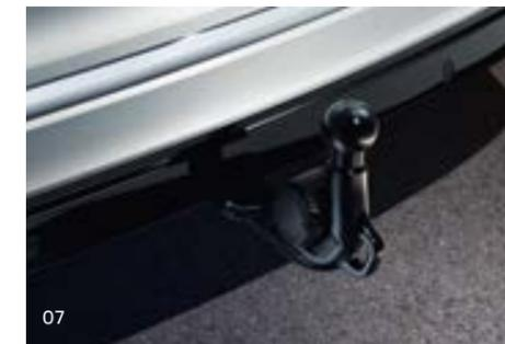
07 Для прицепа массой более 2,5 т<sup>2</sup>: тягово-сцепное устройство с поворотным механизмом можно вручную спрятать за бампером и вновь выдвинуть при необходимости. **S0**
