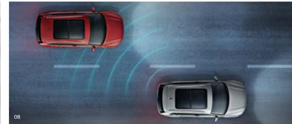
08 Ассистент Side Assist с помощью датчиков в задней части автомобиля контролирует транспорт, находящийся сзади. Если при начале перестроения один из автомобилей находится в слепой зоне или быстро движется по соседней полосе, система предупредит водителя об опасности включением светодиода в наружном зеркале. Также при выезде с парковки задним ходом система предупредит водителя об автомобилях, движущихся перпендикулярно, и может затормозить при опасности столкновения.
